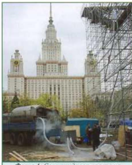
*Фото 1. Слив жидкого азота из транспортной ёмкости (ЦТК-5/0,25) в генератор снега через гибкий металлический рукав*
