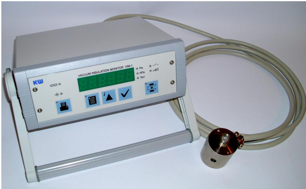
Beim VIM-1 Vacuum Insulation Monitor handelt es sich um ein Reibungsmanometer, bei dem eine rotierende Stahlkugel als Sensor verwendet wird. Dieses Messprinzip hat sich seit Jahrzehnten bewährt und ist weltweit wegen seiner ausgezeichneten Reproduzierbarkeit als Transferstandard anerkannt. Das VIM-1 wurde speziell für die Messung abgeschlossener Vakuumsysteme entwickelt.
