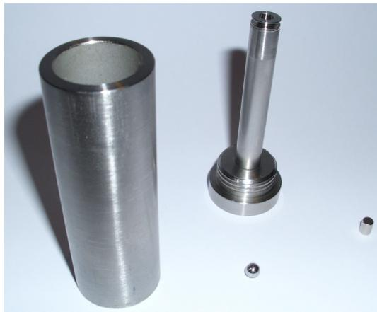
Schutzrohr, Messrohr, Sensorkugel und Haltemagnet (von links)
